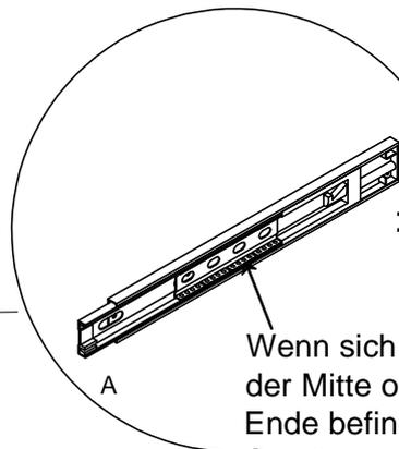
Wenn sich die Stahlkugel in der Mitte oder am hinteren Ende befindet, bewegen Sie die Stahlkugel nach vorne und legen Sie sie in die Schublade.
