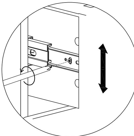
Wenn der Abstand zwischen Schublade und Schrankwand zu gering ist oder eine Kollision vorliegt, lockern Sie bitte die Schraube und stellen Sie die Schublade nach unten oder oben ein.
