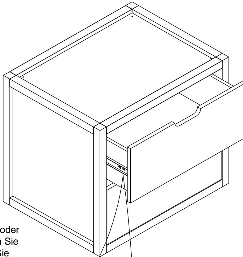
Wenn es hier Reibung gibt oder die Schublade blockiert, lösen Sie die Schraube und passen Sie die Position an:
